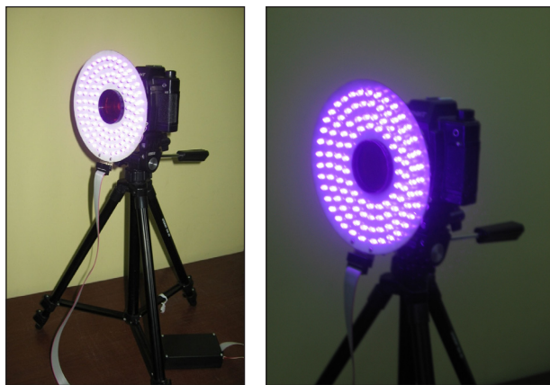
Рис. 1. Установка для in vivo селективной колориметрии биотканей
